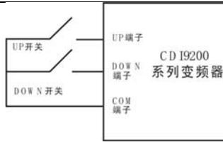
图6.1.1 频率给定8、9方式时，接线示意图
