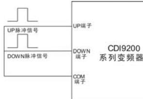
图 6.1.2 频率给定 10、11 方式时，接线示意图
