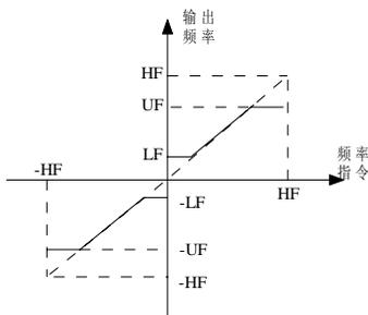
图6.1.11 极限频率参数定义示意图
