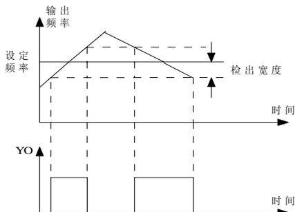
图6.2.13 频率到达信号及频率到达检出宽度示意图
