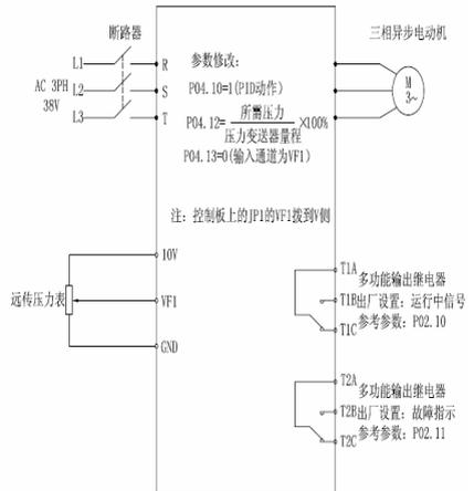
图四：恒压供水PID控制图（远传压力表）
