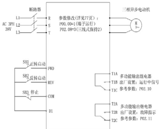
图七：三线式保持控制方式
