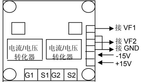
一般情况下，只需接比例流量信号就可以完成一般注塑机的变频节能改造，满足其产品的工艺要求，要求高的情况下要接两路信号。
