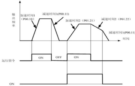
图 6.1.10 两种加减速时间的切换
