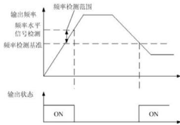
图6.2.16 输出频率 $\leq$ 频率检测基准
