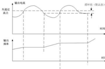
图6.4.2 加速中失速过流保护
