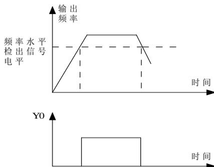
图6.2.14 频率水平检出信号示意图
