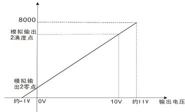
图6.2.18 模拟输出零点2及满度点2
