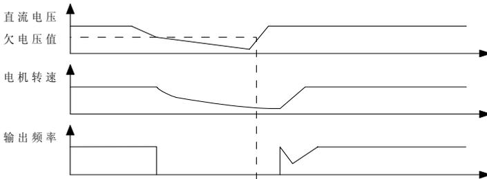
图6.2.2 转速跟踪停电再启动示意图
