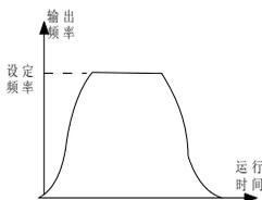
图 6.1.8 S 曲线加减速
