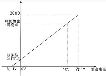
图6.2.17 模拟输出零点1及满度点1
