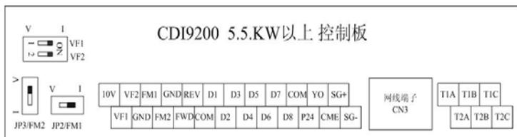
下面是主回路和控制回路的接线图。使用数字键盘操作时，只要连接上主回路就能运行电动机。
