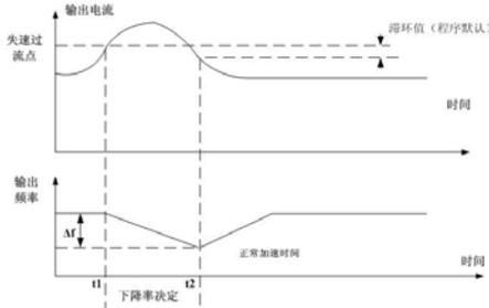
图6.4.3 恒速中失速过流保护
