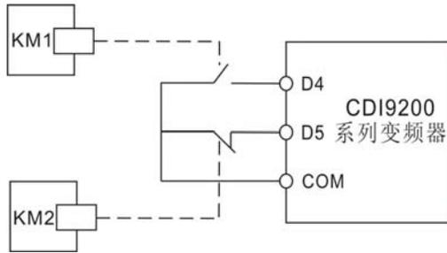
图 6.2.8 外部设备故障常开/常闭输入示意图
