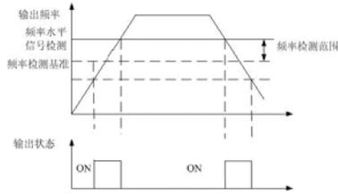
图6.2.16 输出频率=频率检测基准
