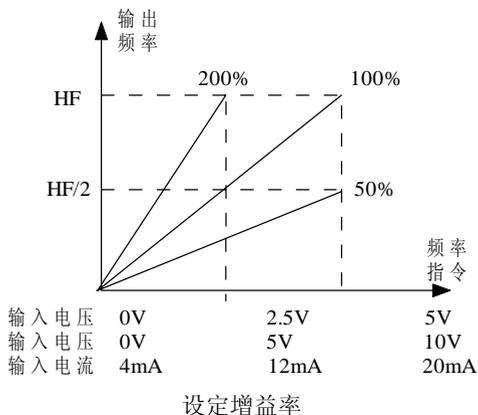
**例：**使用外部0—10V输入信号VF2时，频率调节范围为0.00HZ—50.00HZ，可设定最大频率（P00.04）=50.00HZ，上限频率（P00.12）=50.0HZ，如现场只能给出0-8V的信号，那么此时可设置如下：模拟量输入端子VF2选择（P02.19）=0，模拟输入偏置频率（P02.21）=0HZ，模拟输入信号频率增益（P02.22）=125.0%。如此时不能达到50HZ，可以通过P02.21调节达到。
