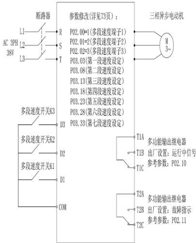
图五：变频器多段速控制图
