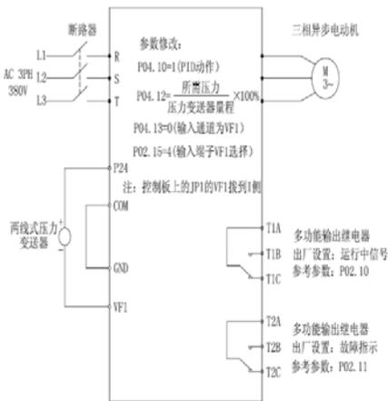
图三：恒压供水PID控制图（压力变送器）
