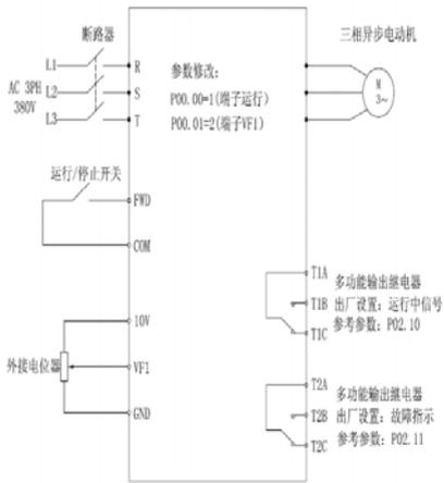
图一：外部启停、外部电位器调速图
