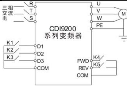
图6.2.6 多段速度运行接线图
