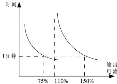
图6.1.12 过载保护反时限特性曲线
