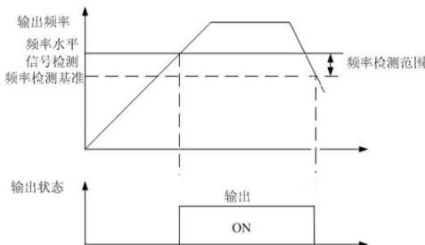
图6.2.15 输出频率  $\geq$  频率检测基准
