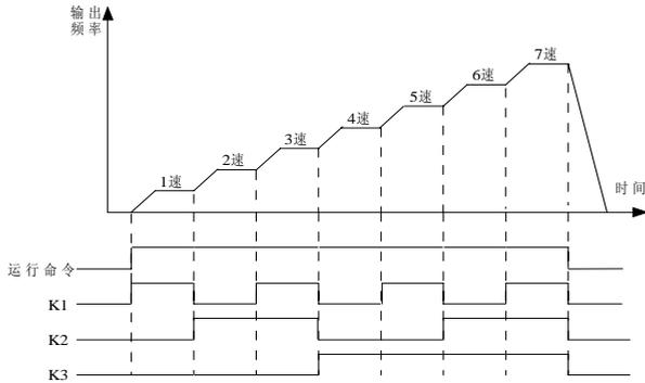
图6.2.7 多段速度运行示意图
